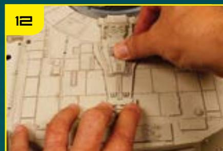
12 Нанесите на штифты немного клея и плотно прижмите деталь к обшивке.
