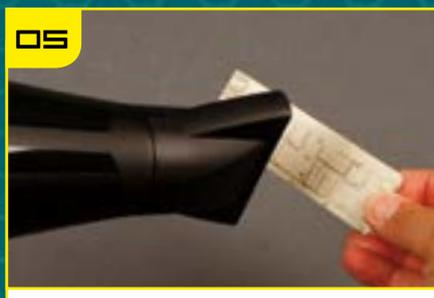
05 Если съемная панель изогнулась, вы можете выпрямить ее, нагрев феном и прижав к плоской поверхности, пока она остывает.
