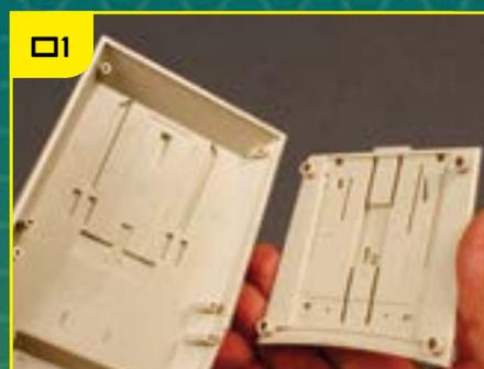
Кожух пусковой установки имеет четыре гнезда для соответствующих штырей фрагмента ВР-28.
